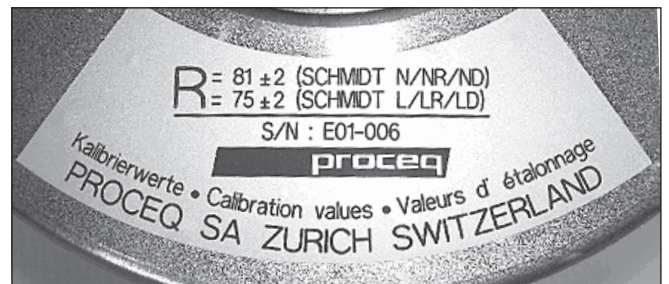
Fig. 4 Schild mit Angabe der Kalibrierwerte Sticker displaying calibration values
