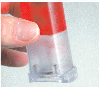
A gélben megkötött kálium-klorid oldat nem tud kifolyni
