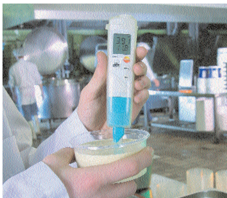
A testo 206-pH2 ideális erősen képlékeny anyagokban történő mérésekhez.
